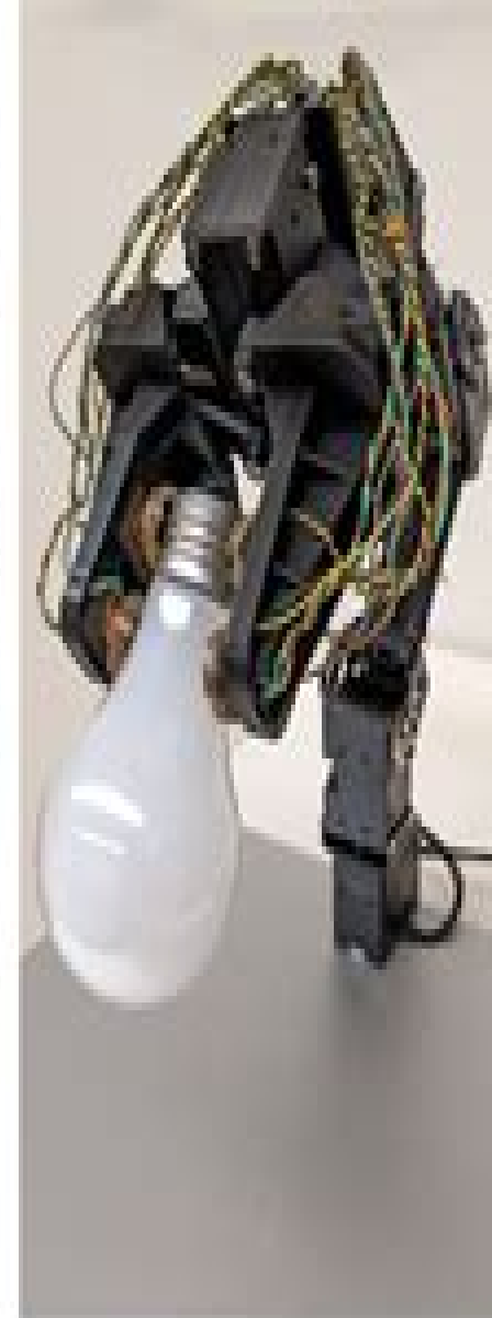
(d) Tactile sensing modules holding an object.
